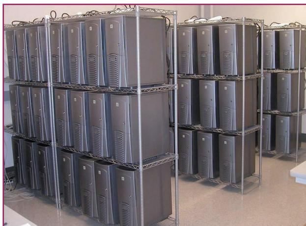
Le cluster de Beowulf Lab composé de 61 nœuds et totalisant 128 processeurs
