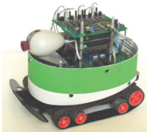
Fig. 1.10 : Robot EvBot-II équipé de son antenne à 8 microphones
