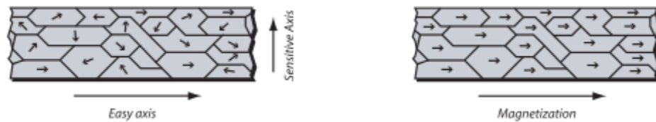
Figure 2.10 : Magnétisation du vecteur de charges du magnétomètre [11]
