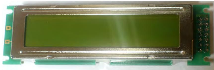
Figure 3.5: Afficheur LCD
