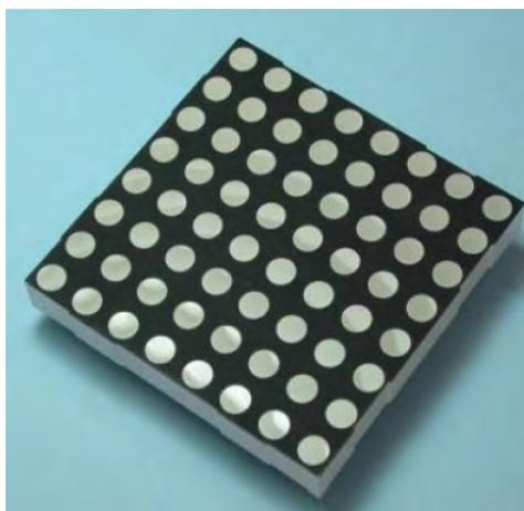
Figure 3.9: Matrice à LED (Dot Matrix)
