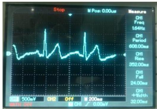
Figure 13–, Tracé ECG visualisé sur oscilloscope
