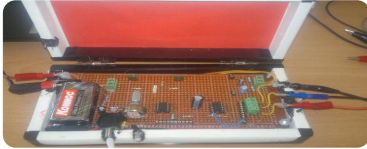
Figure 12 –Circuit ECG sur plaque d'essai.
