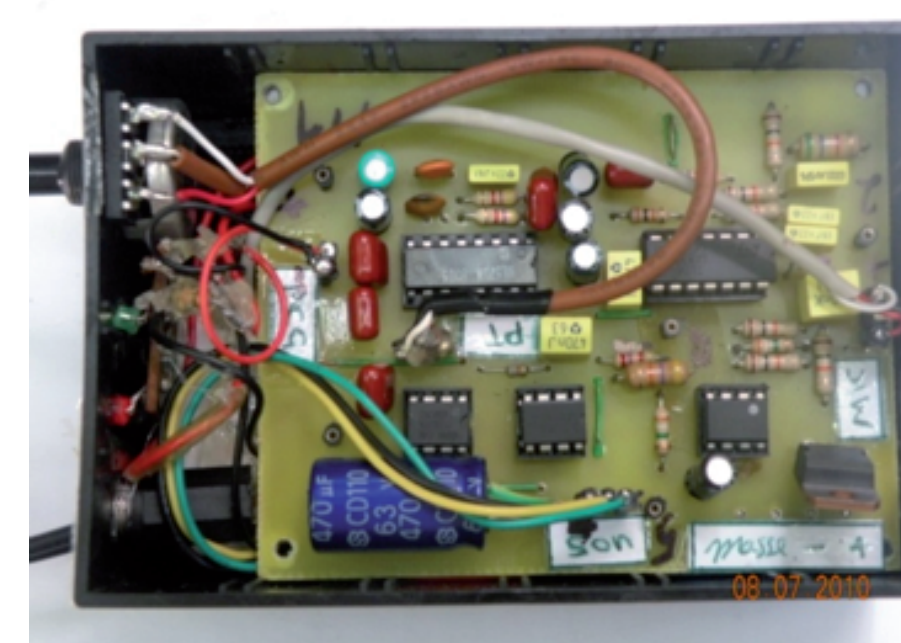
Circuit relatif au signal Phonocardiogramme PCG et résultatsle signal acquis à travers le dispositif réalisé est affiché sur une fenêtre interactive permettant d'enregistrer aussi les données patient
